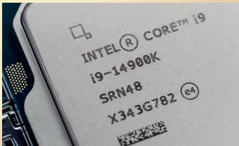
Modellnavnet på Intel-prosessorer avslører hvilken generasjon modellen tilhører. Her viser i9-14900K at den er fra 14. generasjon.
