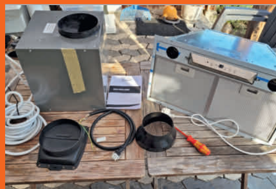
Liesituulettimen (oik.) lisäksi tarvitaan ulkoinen moottori ja sen kotelo (vas.) sekä pitkä ohjainjohto niiden väliin.
