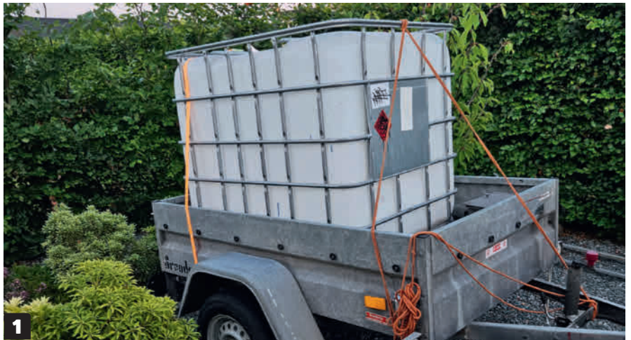
Tämä tuhatosen litran vesisäiliö on 116 senttiä korkea, 100 senttiä leveä ja 120 senttiä syvä. Sen ympärillä on metallikehikko, joka suojaa säiliötä kolhuilta. Kehikko toimii myös hyvänä alustana säiliön ympärille asennettavalle puukoolaukselle.
