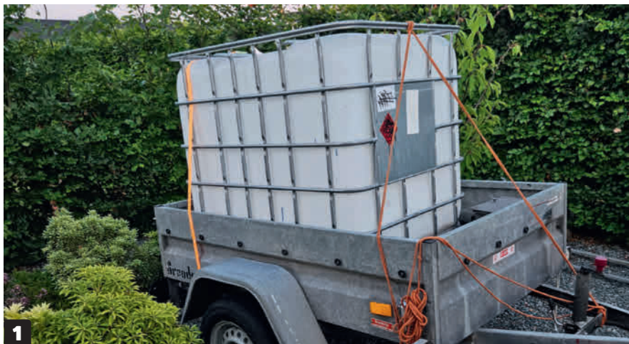
En 1.000-liters vattentank som den här är 116 cm hög, 100 cm bred och 120 cm djup, och så omgärdas den av en metallbur som ska skona själva tanken under transport. Buren fungerar som tur är också perfekt om du behöver ett stabilt underlag till panel.
