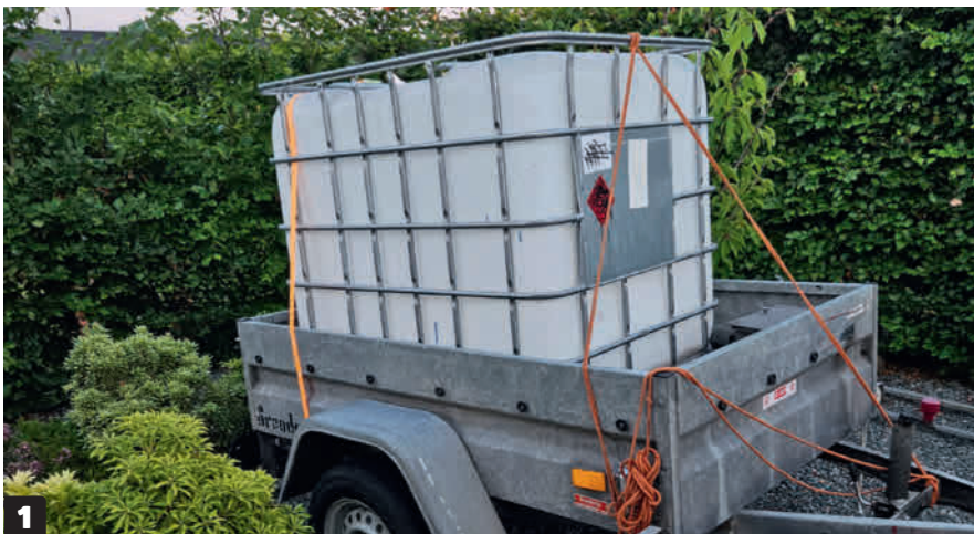
En 1.000-liters vandtank som denne er 116 cm høj, 100 cm bred og 120 cm dyb, og så er den omkranset af en metalramme, som skal skåne selve tanken under transport. Rammen fungerer heldigvis også perfekt, hvis du skal bruge et solidt underlag til beklædning.
