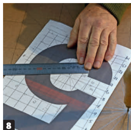
8 Nummerer alle kompassrosens streker, mål avstanden fra sentrum til den innerste sirkelen (radius), og overfør avstanden til MDF-platen. Her på linje 21 er den innvendige avstanden 4 cm.
