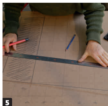
5 Strek opp de skrå og rette linjene (her den øverste delen av 5-tallet). Det gjøres ved å måle på kvadratnettet. Vinkelen kan også overføres med en smygvinke.
