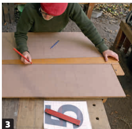
3 Tegn et tilsvarende kvadratnett på en MDF-plate. Vi skal forstørre papirmalen fire ganger, så her blir feltene 8 x 8 cm. Platen kommer til å fungere som en mal.
