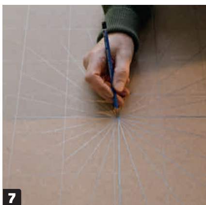
7 Strek opp kompassrosen med en vinkelmåler, slik at det blir 15 grader mellom hver strek. Når den øverste delen av rosen er ferdig, forlenges alle strekene med en lang linjal.
