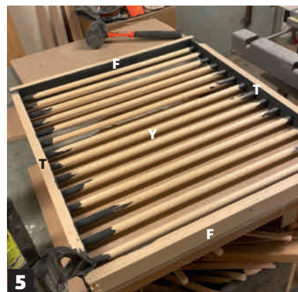
5 Paina rimat (Y) paikoilleen reikiin vaaka-rimoihin (T) ja ruuvaa sen jälkeen pystyrimat (F) kiinni. Sen jälkeen asennetaan kisko (Z), joka liikkuu rimassa (K) olevassa urassa, kun pinnaosa pannaan paikalleen.
