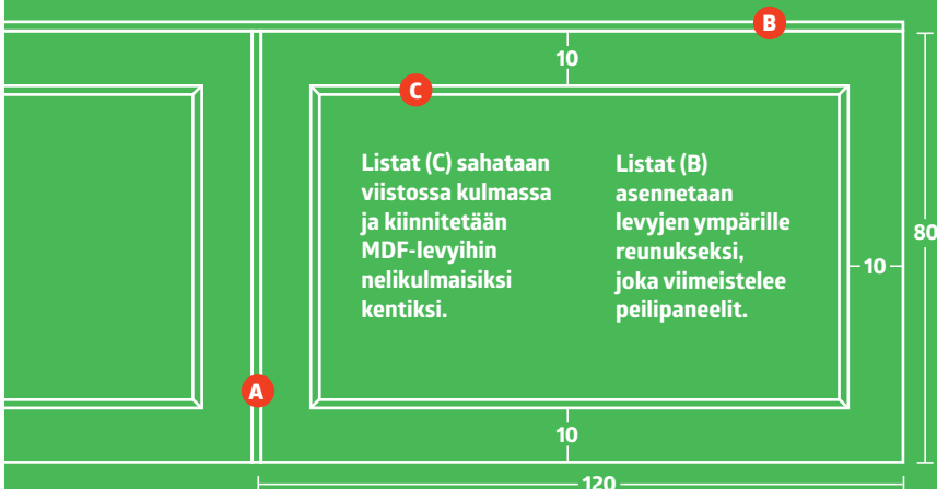
Listat (A) asennetaan niin, että ne peittävät MDF-levyjen väliset raot ja jakavat seinän osiin.
