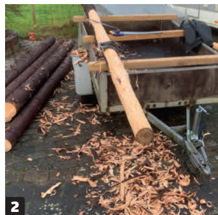
2 Kuoriminen vie aikaa, mutta työ alkaa sujua nopeammin, kun tekniikka tulee tutuksi. Toinen vaihtoehto on käyttää sähköllä toimivaa kuorijaa.
