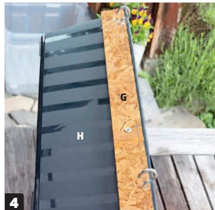
**Sett skrukroker i hullene.** De forborede hullene passer til tre 3 x 40 mm skrukroker. De skrus i, slik at det bare er selve kroken som er synlig. Åpningen skal vende nedover, og krokene skal sitte like dypt.
