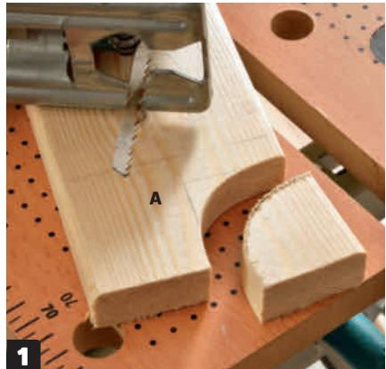
**Tilpass rammelistene (A).** Rundingene nederst på de to rammebordene gjør skjuleren mer "lett" og elegant. De er tegnet etter en rund gjenstand med en diameter på cirka 10 cm og skåret ut med stikksag.
