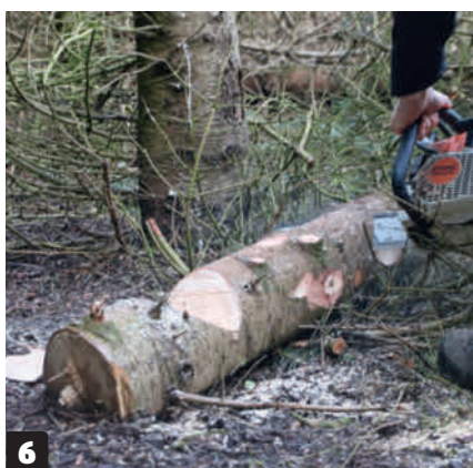
6 Runkoon sahataan kaksi V:n muotoista lovea. Pätvät sahataan irti, ja niistä tehdään sahapukkeja. Sahaustelineen voi tehdä myös muilla tavoilla. Tärkeintä on, ettei runko pääse pyörähtämään.
