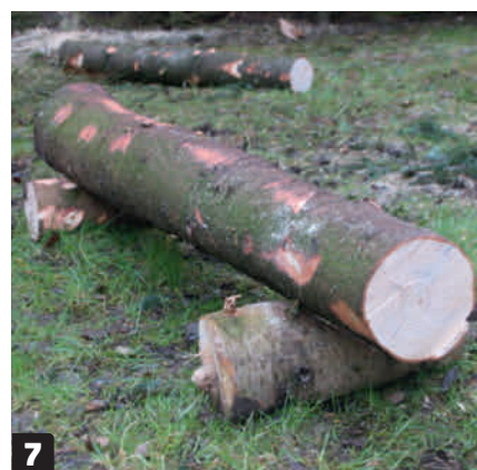
7 Nosta runko pukkien päälle. Se kannattaa tehdä kahdestaan, sillä jo 2–3 metriä pitkä runko on uskomattoman painava.
