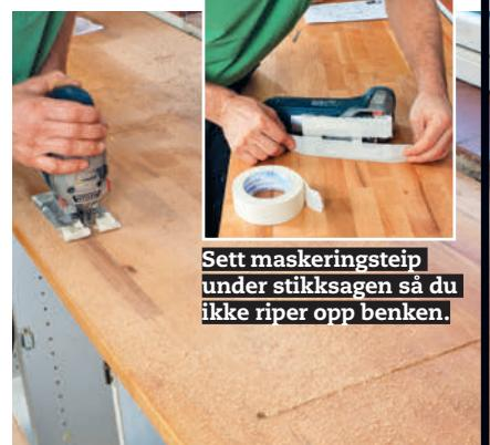
**5 Sag ut med stikksagen.** Start i et av hullene i et hjørne, og følg streken hele veien rundt. Husk å holde stykket du sager ut hele tiden, slik at det ikke knekker av og gjør at hullet blir stygt.
