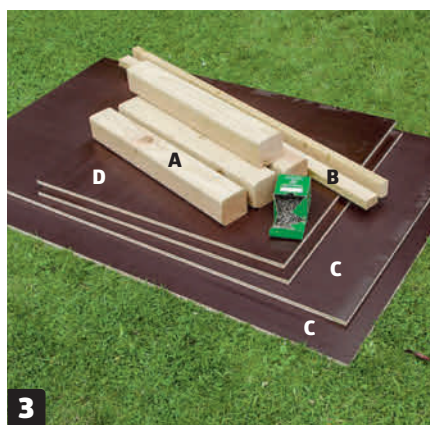
Kaikki osat on sahattu. Vanerinpalasten (C ja D) lisäksi laatikkoon tarvitaan nurkkatolpat (A) ja kaksi rimaa (B), jotka tulevat nurkkatolppien väliin.
