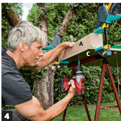
Asenna nurkkatolpat (A) 4x50 millin ruuveilla vanerilevyihin (C). Muista porata ruuveille valmiit asennusreiät, jotta puu ei halkea. Kiinnitä nurkkatolpat puristimilla ruuvaamisen ajaksi.
