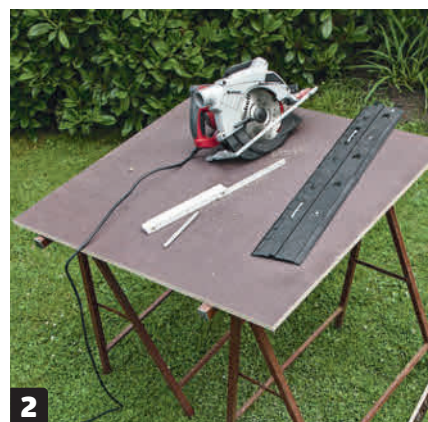
Sahaa seinät muottivanerista. Se on helppoa upotussahalla ja ohjainkiskolla. Voit käyttää myös käsisirkkelä.
