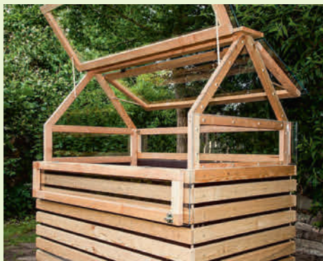
De två stora takramarna kan låsas i öppet läge med en rundstav på vardera sidan.
