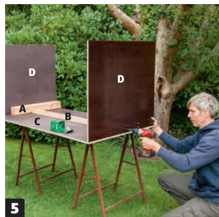
5 Saml kassen. Den tværgående liste (B) mellem hjørnestolperne (A) skrues fast, og de korte sidestykker (D) monteres. Den tværgående liste fastgøres med 4 x 50 mm skruer gennem støbekrydsfinerpladen.
