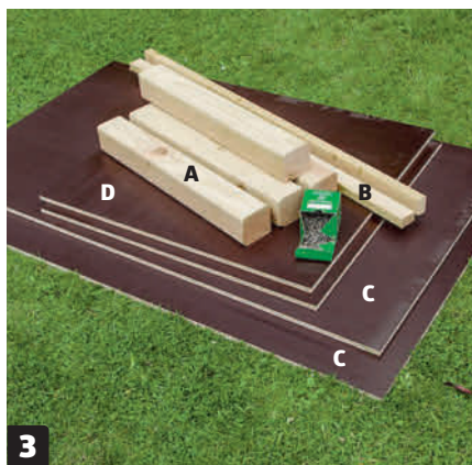
3 Alle dele er savet ud. Ud over siderne (C og D) i støbekrydsfiner er der fire hjørnestolper (A), som siderne skal fastgøres til, samt to lister (B), der skal monteres mellem hjørnestolperne.
