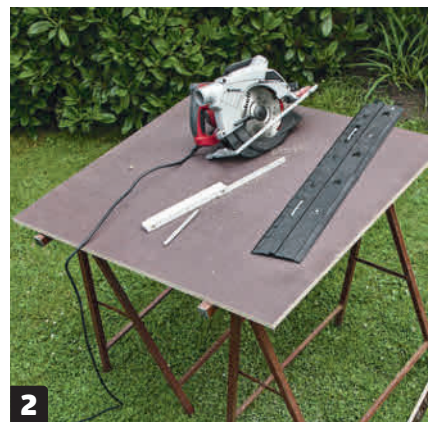
2 Siderne saves til af støbekrydsfiner, når du har besluttet dig for, hvor høje de skal være. Det er nemt, hvis du har en dyksav med føringsskinne. Du kan også save med en rundsav langs en retsskinne.
