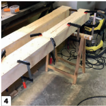
4 Tylsän näköisen tolpat jäävät uritettujen lautojen alle, jotka täydentävät vaikutelman. Kaikki tehdään valmiiksi verstaalla ennen asentamista.
