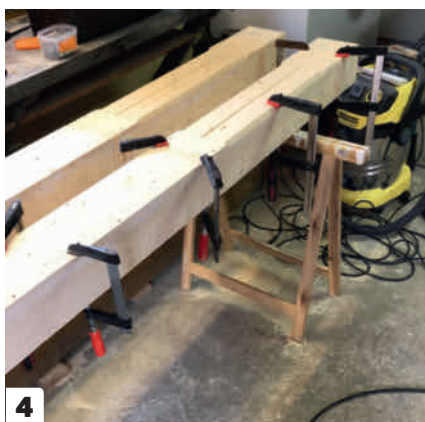
4 De lite tråkiga stolparna kläs in med profilerade brädor för att fullända utseendet. Återigen görs allt i verkstaden innan det monteras.
