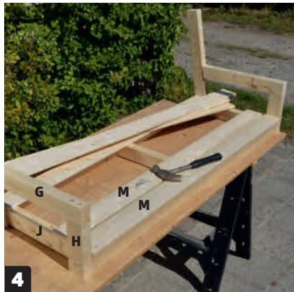
**Spikre fast bordene (M)** med galvaniserte dykkert. De små spikerne er mer diskrete enn skruer, og synes stort sett ikke når de males over.
