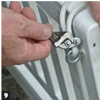
**Skru fast en kraftig øyeskrue** på baksiden av ryggen – en i hver side i toppen av F. Trekk linen gjennom, og sett den fast med en wirelås. Bor et 10 mm hull i benkesiden gjennom H og J, og bind et par knuter.
