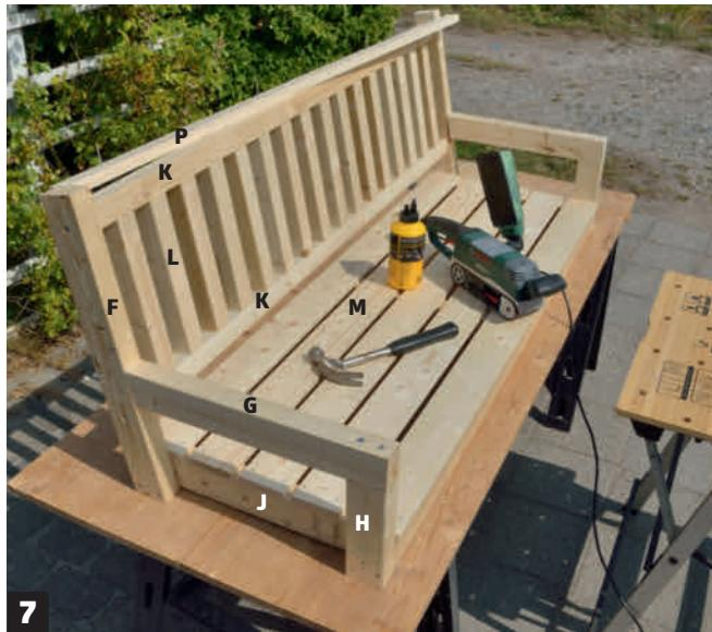
**Skru fast ryggen (K og L) til de lange sidestykkene (F)** med lange skruer, 6 x 180 mm, som skrus inn i de vannrette ryggdelene (K). Det settes også en lekt (P) øverst på ryggen (K), som flukter med det lange sidestykket (F).
