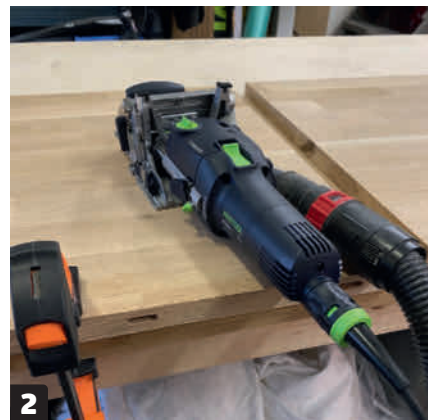
2 Vi använder vad som kallas en lamellfräs. Maskinen gör mycket exakta ovala urfräsningar i olika djup och tjocklekar.
