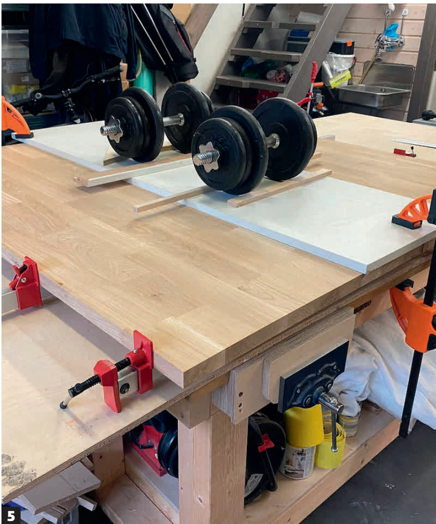
5 Spänn ihop de två delarna ordentligt och håll dem på plats med något tungt medan de torkar. Se till att ta bort överflödigt lim omedelbart så att mellanläggerna inte fastnar på bänkskivan. Efter limningen är fogen nästan osynlig. Istället för de långa skruvtingarna kan du använda spännband till ett släp.
