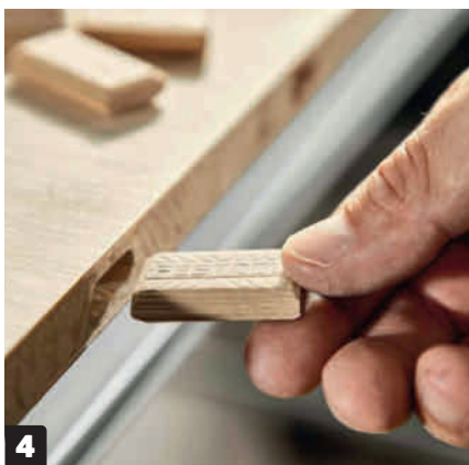
4 Lamellkexen är gjorda av bok, vilket gör dem otroligt starka. De finns i bredder från 4 till 10 mm och längder från 20 till 140 mm.
