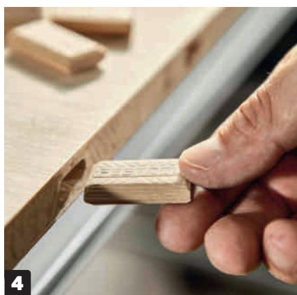
4 Dominopluggene er laget av bok, noe som gjør dem veldig sterke. De kan fås i bredder fra 4 til 10 mm og i lengder fra 20 til 140 mm.
