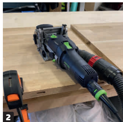
2 Pluggfresen vi bruker, kalles en Domino-maskin. Maskinen lager nøyaktige ovale utfresinger i forskjellige dybder og tykkelser.
