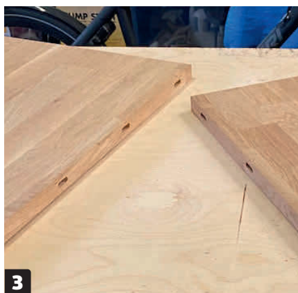
3 Pluggene skal sitte med cirka 20 cm avstand. Legg platene mot hverandre når du merker opp til pluggene – da er du sikker på at utfresingene ender overfor hverandre.
