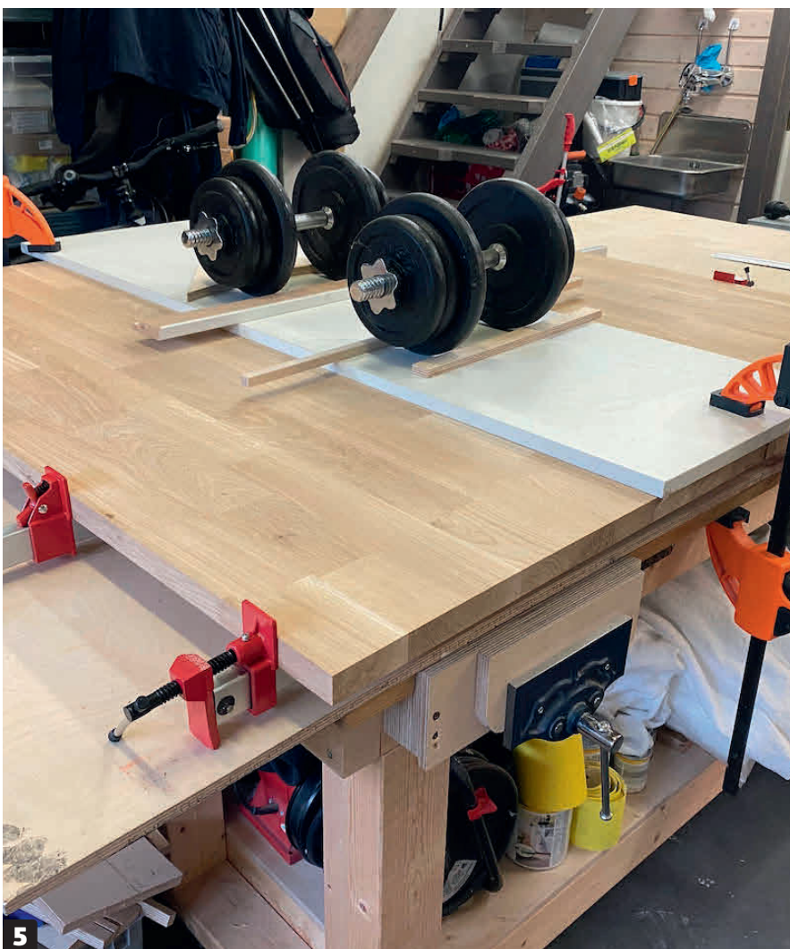
5 Spenn de to delene grundig sammen, og hold dem på plass med noe tungt mens de tørker. Sørg for straks å fjerne overskytende lim, slik at mellomleggsplatene ikke ender med å sitte fast på bordplaten. Etter limingen er sammenføyningen nesten usynlig. I stedet for lange skrutvinger kan du også bruke jekkstopper.
