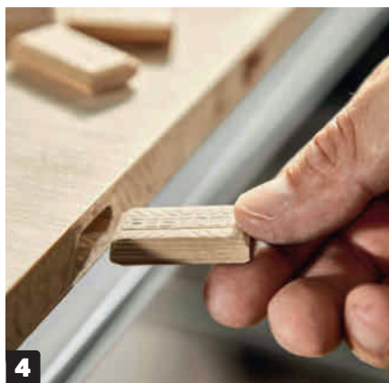
4 Dominobrikkerne er lavet af bøgetræ, hvilket gør dem utrolig stærke. De kan fås i bredder fra 4 til 10 mm og i længder fra 20 til 140 mm.
