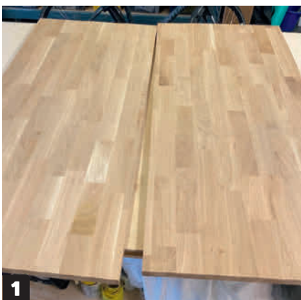
1 Pladen, vi bruger, er en billig stavlimet egetræsplade, som kan købes i de fleste byggemarkeder. Bordpladen er til at starte med 305 cm lang, men deles på midten.
