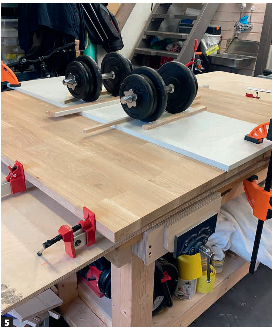
5 Spænd de to dele grundigt sammen, og hold dem på plads med noget tungt, mens de tørrer. Sørg for at fjerne overskydende lim med det samme, så mellemlægspladerne ikke ender med at sidde fast på bordpladen. Efter limningen er samlingen næsten usynlig. I stedet for de lange skruetvinger kan du bruge spændestroppe fra en trailer.
