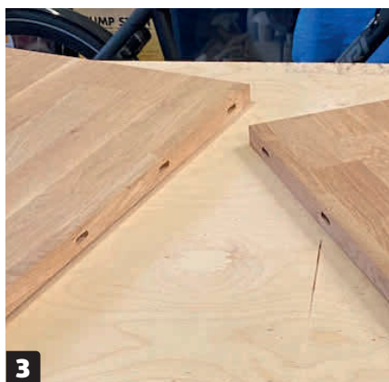
3 Brikkerne skal sidde med ca. 20 cm afstand. Læg pladerne over for hinanden, når du mærker op til samlebrikkerne – så er du sikker på, at udfræsningerne ender over for hinanden.
