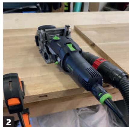
2 Samlefræseren, vi bruger, kaldes en dominomaskine. Maskinen laver meget præcise ovale udfræsninger i forskellige dybder og tykkelser.
