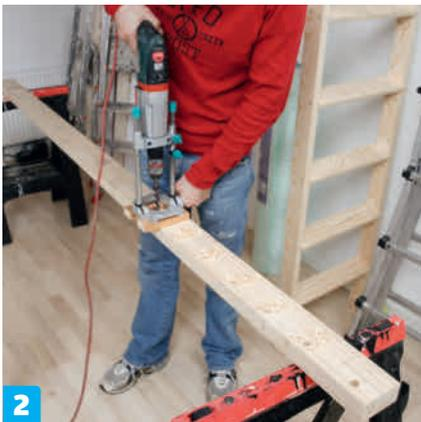
**Nå skal det bores.** Vi bruker et 16 mm spiralbor og en bormaskin i et borstativ. Vi borer 30 mm dype hull i håndlistene (J og K), mens vi borer 40 mm dype hull i rammen. Hullene støvsuges rene for flis.
