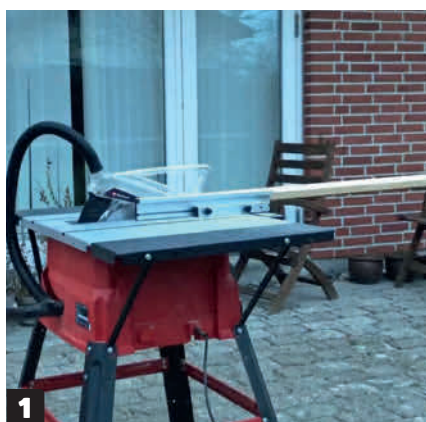
1 Skær sokkel og sidepanel til. Soklen bygges i billige lægter, og sidepanelet laves i MDF-plade.
