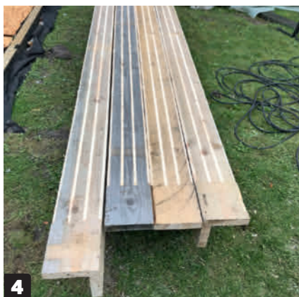
4 Du kan enkelt piffe opp en småkjedelig stolpe med en overfres. Ved å frese en rekke parallelle spor, blir overflaten på stolpene helt annerledes i uttrykket.
