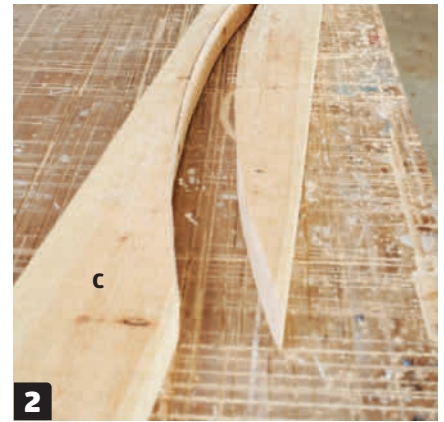
Såga efter det bågformade strecket med en sticksåg. Markera mitten på de övriga sex överliggarna (C) och använd den utsågade bågen som mall.
