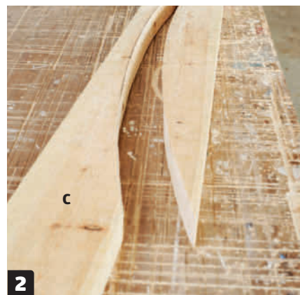
2 Sag etter den buede streken med en stikksag. Strek opp midten på de øvrige seks overliggerne (C), og bruk den utsagde buen som mal.
