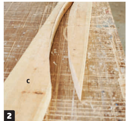
Sav efter den buede streg med en stiksav. Streg midten op på de øvrige seks overligger (C), og brug den udsavede bue som skabelon.
