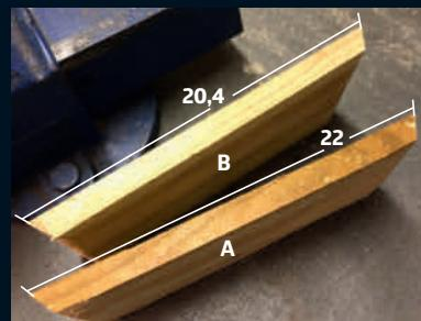
En regulær sekskantet kasse bygges med seks like lange sider (A). De kappes med 30° snitt i endene, slik at de danner en vinkel på 120° når de settes sammen. Kassen deles opp i rom med seks vegg (B) som er 20,4 cm lange. Også veggdelene (B) kappes 30° i endene.
