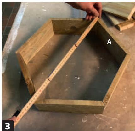
**Sjekk diagonalmålene på kassen.** De skal være like lange på alle tre diagonaler for at kassen skal se harmonisk ut. Du kan justere det på plass, hvis det er behov for det.
