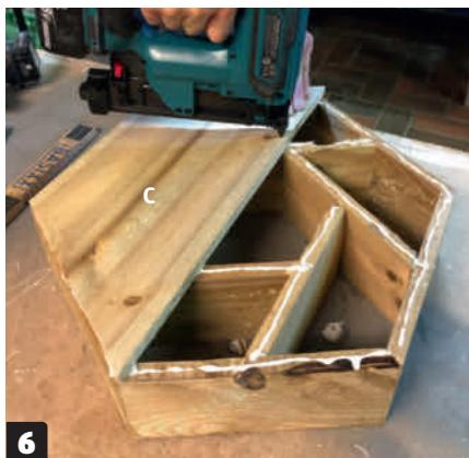
**Monter en bakkledning (C),** slik at kassen blir tett på baksiden. Her består bakkledningen av bord. Kassen legges oppå bordene, og det tegnes opp. Bordene kappes til og limes/spikres fast.
