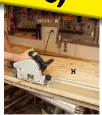
**3** Sag det overskytende av det siste bordet, sånn at gulvet flukter med sidene på bunnrammen hele veien rundt. Slip overflaten med slipepapir, slik at gulvet blir helt glatt.
