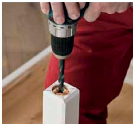
**3** Deretter borer vi ut til islagsmutteren med et 12 mm bor. Hullet skal være så dypt at det er plass til hele justerskruen.
