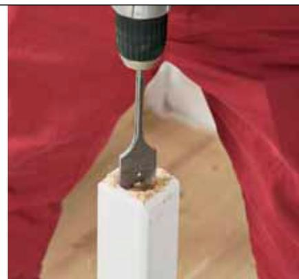
**2** Forbor med et spadebor til den bredeste delen av justerskruen (foten). Hullet skal være så dypt at hele foten kan forsvinne opp i bordbeinet. Her er den bredeste delen av skruen 30 mm bred, så vi bruker et 35 mm spadebor.
