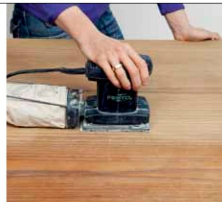
**2** Når platen er tørr, slipes den med plansliper eller eksentersliper. Først slipes bordplaten med korn 100. Deretter skal det slipes med korn 200. Fjern alt slipesøvet med en tør klut.
