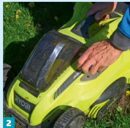
2 Säädä ruohonleikkurin terä matalimpaan asentoon. Ruoho pitää leikata niin lyhyeksi kuin mahdollista, jotta työ sujuu helposti.
