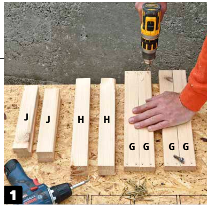
1 Esiporaa osiin reiät ruuveja ja ruuvinkantoja varten, jotta puut eivät halkea kasaussvaiheessa.
