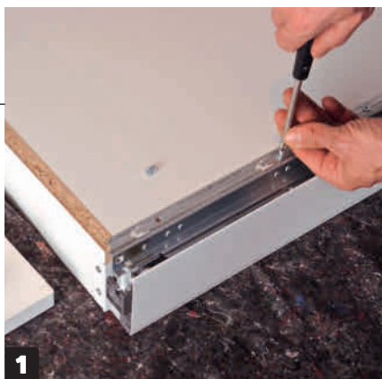
1 Ruuvaa liukukiskot laatikon pohjaan ja takalevyyn. Tapeilla ja ruuveilla koottavat laatikot kootaan tällä tavalla.
