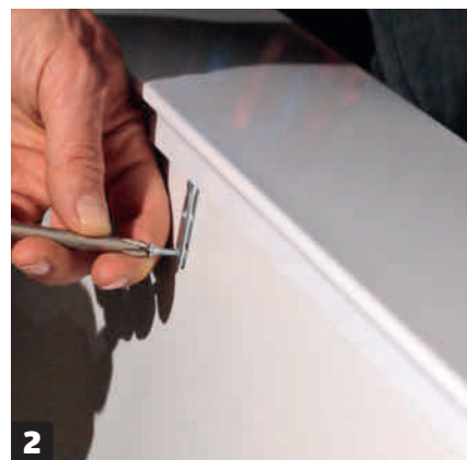
2 Kiinnitä etulevy pienellä kiinnikkeellä. Leveän laatikon etulevy pitää kiinnittää pohjaan myös keskeltä. Sitä ennen etulevy asennetaan laatikon reunoihin jousitetuilla kiinnikkeillä.
