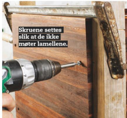
**4** Sammenføyningen låses med skruer fra siden som gardering. Det kunne bli stygt – men blir fint når skruen dekkes av en 12 mm treprop. Skruen er en 5 x 80 mm skrue som vi borer opp til med et 3,5 mm bor midt i hullet til proppen.
