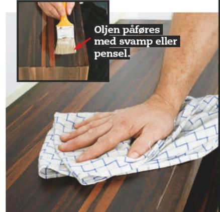
**7** Siste omgang med olje venter vi med til kassa henger på veggen. Da har kassa fått fem strøk med olje, vi har slipt oljen ned med fint slipepapir, latt treet suge 15–20 minutter og polert av den overskytende oljen til alt skinner som lakk.
