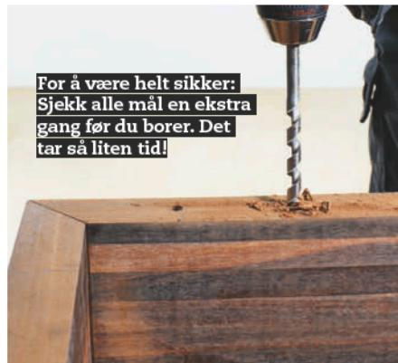
**3** Plasseringen av skruene føres over på bakkanten av kassa. Fordi skruene kan sitte litt skratt, bør du måle deg fram fra streken på veggen og fra den innvendige siden av hylla. Hullene i hylla bores med et 8 mm trebor med borespiss.
