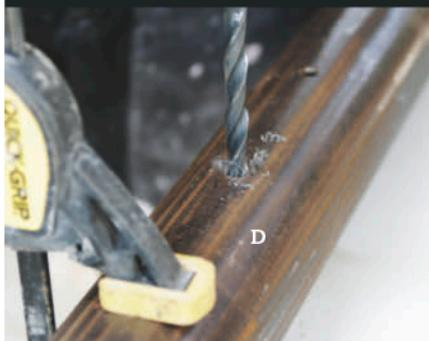
**1** Bor 5–10 hull i røret (D) med et 10 mm bor slik at du kan justere grillrista opp og ned. Riss opp ei midtlinje på røret før du borer slik at hullene kommer til å ligge på ei rett linje.
