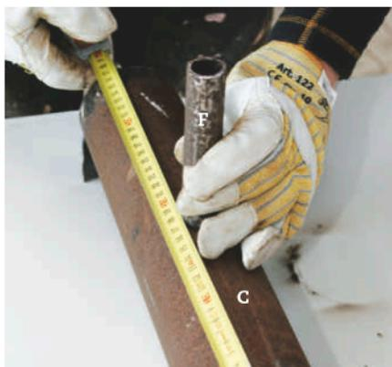
**6** Sveis fast et håndtak (F) midt på røret til rista (C). Skjær ca. 12 cm av et ett-toms rør, og plassér håndtaket midt på røret på den motsatte siden av platebiten.
