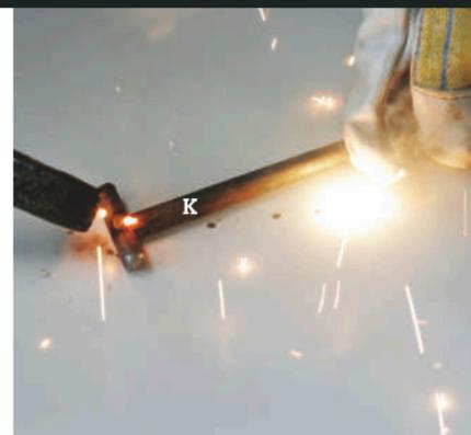
**6** Lag en splint (K) slik at du kan justere høyden på rista. Skjær 14 cm av et 8 mm rundjern, og sveis et kort tverrstykke eller eventuelt en ring i enden.
