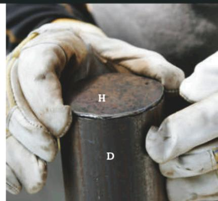
**3** Snu plata (H) rundt og sveis den fast i toppen av røret (D). Når plata buler utover, kan det ikke stå vann på den, og røret er beskyttet mot regnvann.
