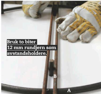
**3** Lag resten av rista av 8 mm rundjern (B). Skjær til stengene med vinkelsliper, og sveis dem fast på ringen. Begynn med den midterste stanga, og hold så samme avstand når du sveiser fast resten. Til sist skjæres de til med vinkelsliperen.
