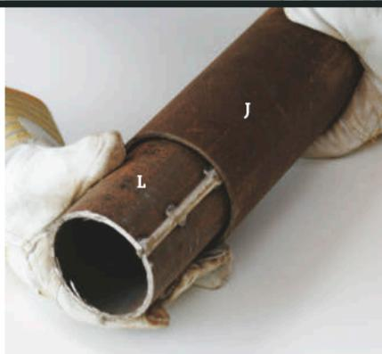
**1** Utvid røret (L) med 3 sveisesømmer eller striper av 1 mm plate. Røret (L) skal sitte på jordspydet og tilpasses slik at det kan gå inn i røret (J) – foten på holderen. Derfor bør det ikke være for mye frigang.
