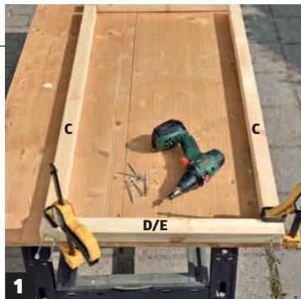
**Lag fire rammere.** To siderammer lages av rammemedlene (C) og (D) og to dørrammer av rammemedlene (C) og to rammendedeler (E). De lange delene legges mellom de korte.
