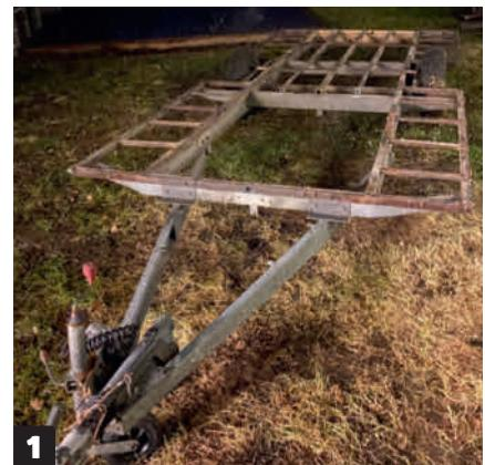
**Et gammelt understell fra en campingvogn** er utgangspunktet for hele konstruksjonen. Det er ribbet helt, slik at det kan bygges opp på nytt.
