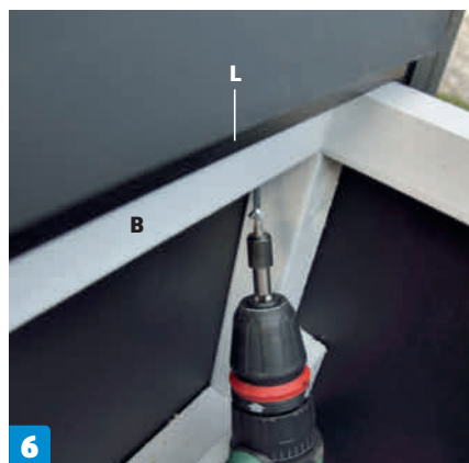
6 Til sidst monteres låget. Skru det fast indfra (og nedefra) op igennem den bageste tværstiver (B) med 5 x 60 mm skruer. Nu er kassen klar til at blive hængt op på muren.
