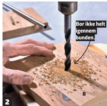
2 Bor et 12 mm hul til stålørret i undersiden af bunden (B). Bor ikke helt igennem – stangen skal jo ikke ryge op til fuglene. Lim evt. en 4 x 4 cm klods midt på undersiden, før der børes. Det giver mere stabilitet.
