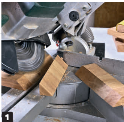
1 Sav alle delene ud efter skæreplanen. Det bedste resultat opnås med en kap-/gerings-sav. Så bliver vinklerne 100 % nøjagtige. Tag højde for, at savklingen laver et spor på 2-3 mm, så stykkerne ikke bliver for små.
