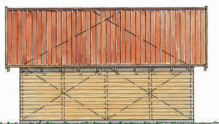
Långsidorna är identiska med klinklagd panel och två förstärkande kryss – och ett i taket.
