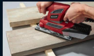
**4** Slip plankene med en eksentersliper. Bruk slipepapir med korn 180.
