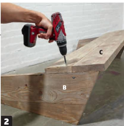
**2** Legg plankene (C) til setet oppå beina (B), og forbor to hull i hver plank i hver ende. Skru deretter fast setep plankene til beina med 6 x 80 mm skruer.
