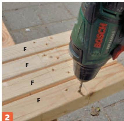
**Slik forborer du til skruene:** Spenn de fire beina (F) sammen, og strek opp på dem. Bor to hull i hver sammenføyning med et 5 mm bor. Strek opp til kledningsbordene og tverrstivernes plassering.
