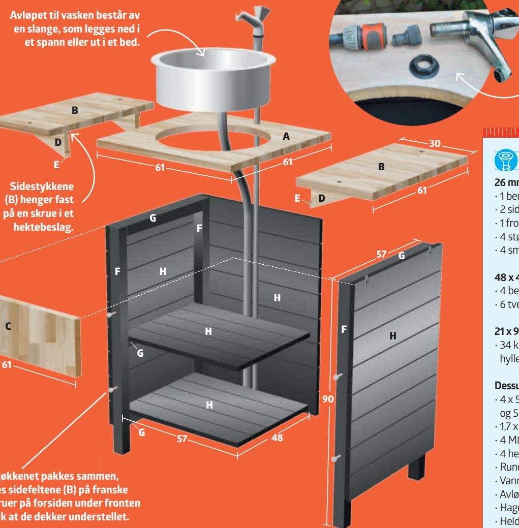
Vannkranen holdes fast med en mutter under benken, og kobles til hageslangen med slangekoblinger.
