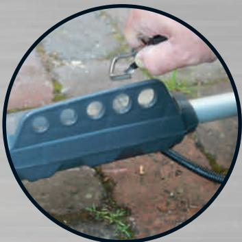
På stangen over håndtaket sitter det en kobling med fem hull, som selen kan hektes i. Vektfordelingen justeres etter hvilket hull du velger.
