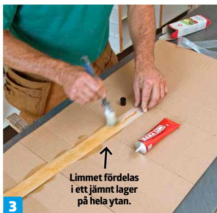
3 Stryk kontaktlim på kantstyckets baksida, och fördela limmet med en pensel.
