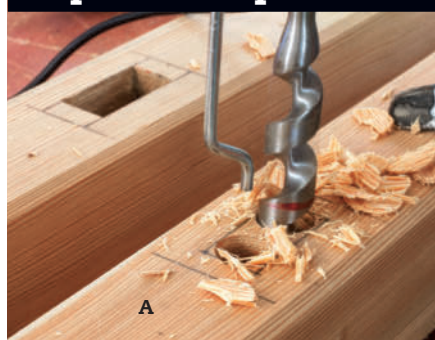
Løsholten monteres med lim og skrue.
