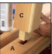
Løsholten monteres med lim og skrue.
