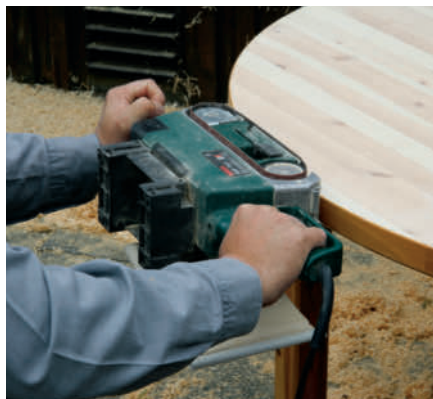
Profilen på stålet føres over på treverket. Kulelageret sikrer at stålet går like dypt i kanten hele veien rundt.
