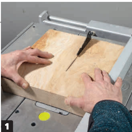
1 Sag til klossene i bredden. I vårt tilfelle vil det si en bredde på 12 cm.
