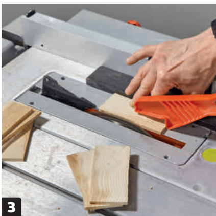
3 Til slutt sages alle skivene til i høyden. Vi sager på begge sider, slik at alle flater blir helt like og jevne. Våre skiver er 5 cm.
