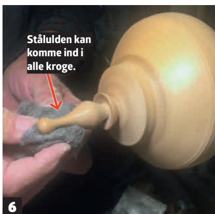
6 Slib knoppen med ståluld. Fordelen ved ståluld er, at du kan komme ind i alle kroge, samtidig med at du næsten ikke fjerner noget træ. Bruger du derimod sandpapir, kan du nemt komme til at ændre på formen.
