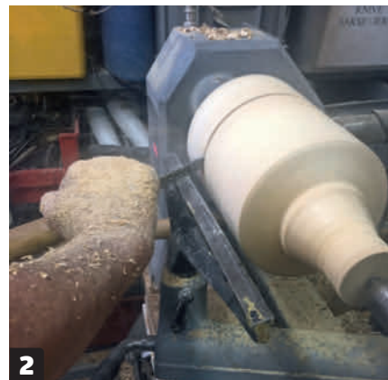
2 Markér bunden på skålen, så du har et overblik over, hvor meget træ du har at arbejde med. Når skålens størrelse er defineret, er det lettere at gøre sig tanker om selve formen.
