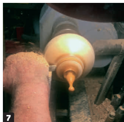
7 Drej med rolig hånd låget af selve skålen med en skrå mejsel. Når du har arbejdet dig 2-3 cm ind, saves det sidste stykke med en nedstryger for at minimere risikoen for at beskadige låget.
