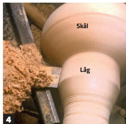
4 Læg en skrå mejsel til rette på landet, og bestem lågets diameter. Det er vigtigt, at "kanten" på låget bliver helt lige, for at det kan slutte helt tæt.
